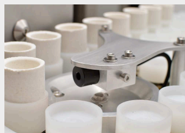
Autocarregador com suportes de cadinhos de plástico resistentes a ácidos
