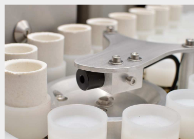
Autoloader cu suporturi pentru creuzete din plastic rezistent la acizi
