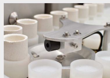
Cargador automático con soportes de crisoles de plástico resistentes al ácido
