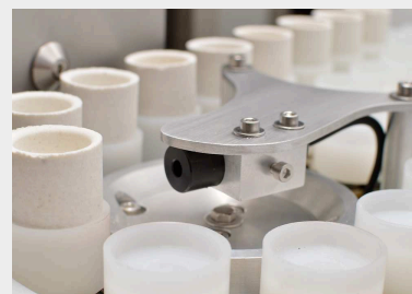
Chargeur automatique avec supports de creuset en plastique résistant à l'acide
