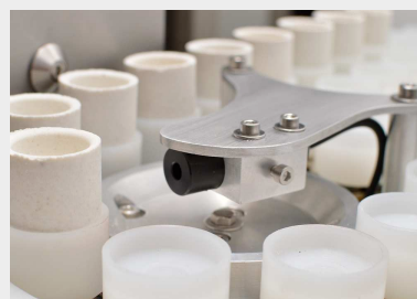
Autoloader mit Tiegelträgern aus säureresistentem Kunststoff
